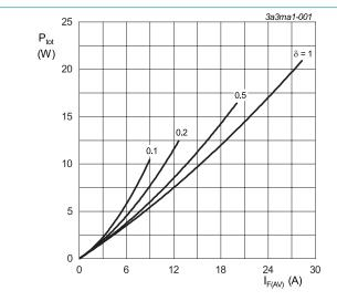
$$\begin{split} I_{\text{F(AV)}} &= I_{\text{F(RMS)}} \times \sqrt{\delta} \\ V_{\text{o}} &= 0.541 \text{ V; } R_{\text{s}} = 0.0070 \text{ } \Omega \end{split}$$
