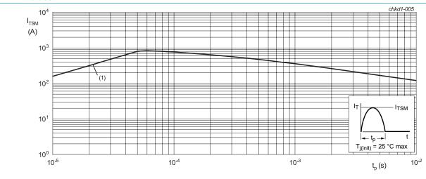
$t_{D} \le 10 \text{ ms}$  $(1) dI_{T}/dt limit$
