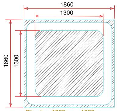
Die size: 1860μm x 1860μm Bond pad size: 1300μm x 1300μm
